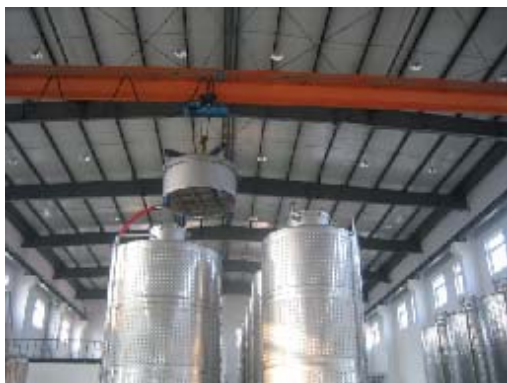
Tout se fait par gravité : pont roulant déplaçant les cuvens.
