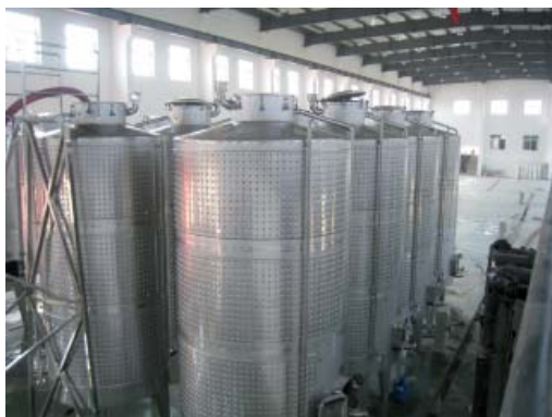
Les cuves thermo-régulées par boucliers thermiques.
